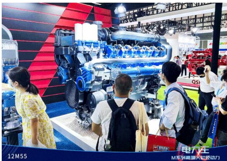
12M55 燃气发动机，也是本次展会“流量担当”。发动机材料全面强化，采用蠕铁机体、气缸盖，可以承受更高的缸内爆发压力；采用智能点火控制器、高能点火系统、先进的控制系统和成熟的控制策略，发动机可实现自动控制，运行更可靠更智能。
