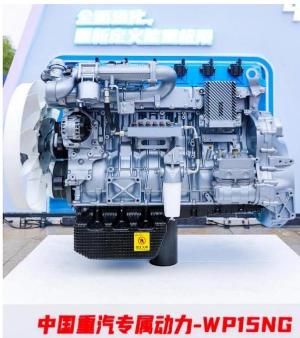
WP15NG 发动机是大马力燃气牵引车专属动力,最大扭矩高达 2500N·m,升扭矩达 171N·m/L,超强配置,无惧复杂路况,动力澎湃;迭代优化燃料喷射装置+EGR 控制装置,精准控制空燃比,百公里整车气耗低 1kg-2kg 左右;历经“三高”试验充分验证,多场景耦合,环境适应性强;制动功率高,达发动机输出功率的 60%,安全系数高。
