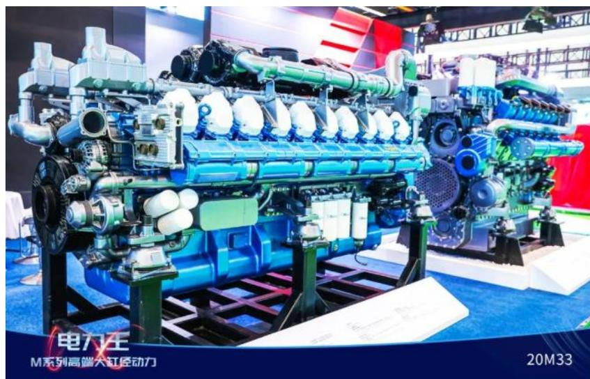
20M33 发动机气缸体采用网格结构设计，缸体强度高；曲轴采用高强度合金钢材料，可靠性高，设计寿命 32000 小时；WISE 系列潍柴自主 ECU，策略标定灵活、安全可靠。
