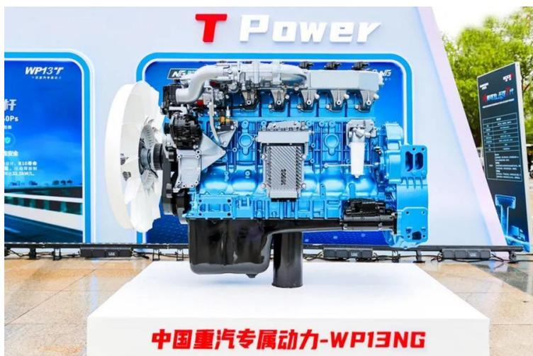
WP13NG 发动机可谓标载物流牵引车专用动力,低速大扭矩,最大扭矩 2300N·m,功率覆盖范围 430Ps-480Ps,动力强劲;火花塞中置,热效率高,全负荷最低燃气,更经济实用。
