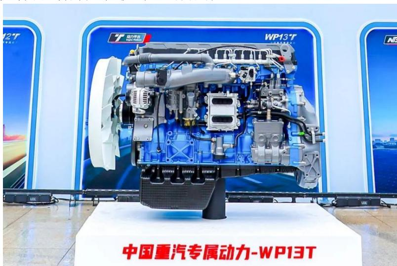
WP13T 发动机最大马力 560Ps，最大扭矩  $2600\text{N}\cdot\text{m}$ ，低速大扭矩，动力强劲，堪称干线物流牵引车专用动力；采用超高轨压燃油系统，油耗低、经济性优；B10 寿命达 180 万公里，制动功率高，安全可靠。
