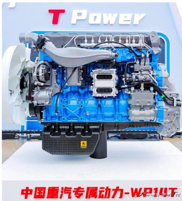
WP14T 发动机作为长途干线牵引车专用动力，最大扭矩 2750N·m，功率覆盖范围 560Ps-610Ps，起步加速快，爬坡能力强，工况适应性更强，动力强劲、自由驰骋；出生即巅峰，采用全球首款本体热效率突破 51%的柴油机平台技术，百公里综合油耗降低 2L 以上，高效节能，省钱有道；发动机保养里程达 12 万公里，稳定可靠，省时省心。
