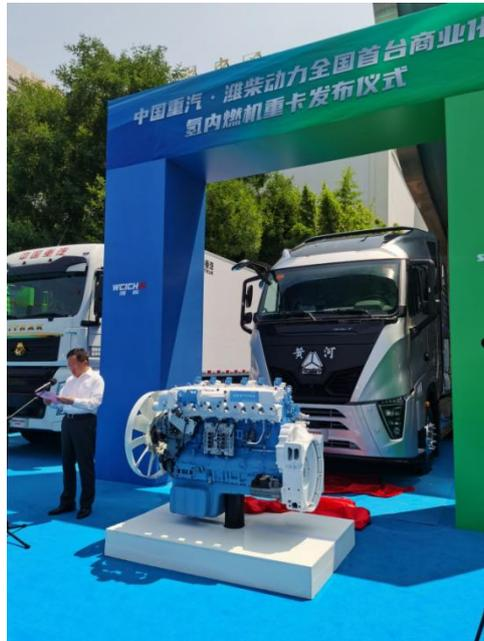
在性能开发和配套应用方面，该车采用了多项专有技术，优势突出——采用精准氢气喷射控制技术，实现氢燃料灵活准确供给，可充分满足发动机变工况需求；采用高效增压、稀薄燃烧技术，解决了氢气异常燃烧难题，确保发动机平稳高效运行；采用潍柴自主ECU系统，智能控制、自主可控，确保控制策略定制化开发；基于已有的气体机产品平台进行技术再延伸，可快速推动商业化落地。
