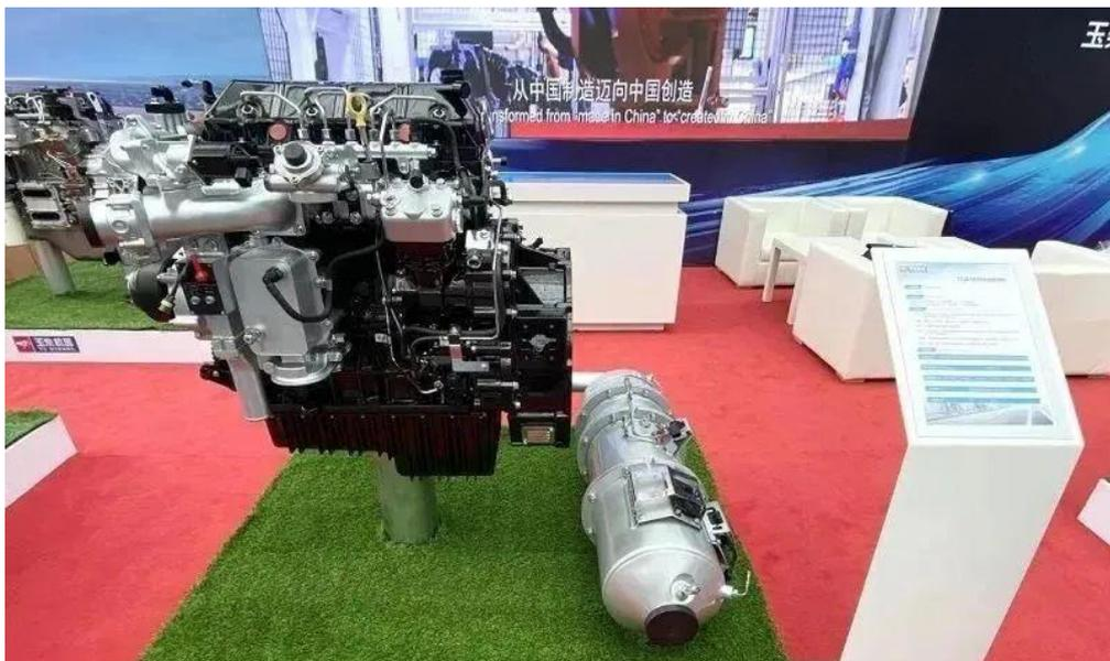
YCS04是玉柴全面升级的新一代中型动力，采用高效燃烧技术，爆发力更强；低速大扭矩，最大扭矩770N·m，较国五机型提升20%；机体采用轻量化、模块
