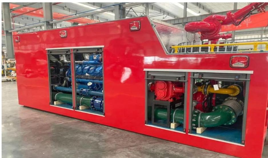
同时，12M33 高端动力使用了特制冷却系统，不畏火场热浪，为近距离控制火情提供源源不断的可靠动力；采用自主 ECU，满足整车设备远程启、停、调整控制等需求，确保操作人员安全。
